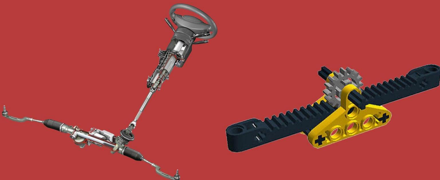
**Реечная передача** - передача с преобразованием вращения ведущего зубчатого колеса в поступательное движение рейки.
