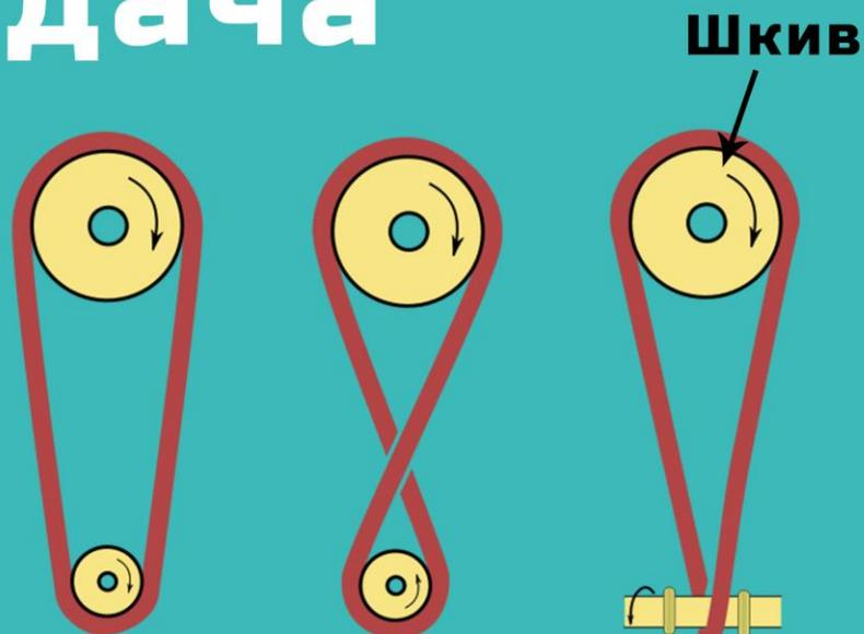
**Ремённая передача** - передаёт и преобразует вращение при помощи ремня (гибкого элемента), за счёт сил трения или сил зацепления (зубчатые ремни).
