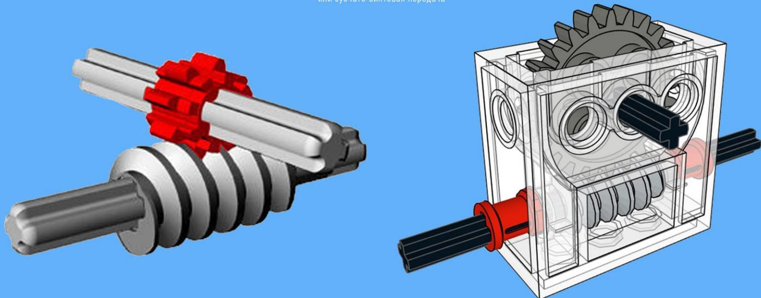
**Червячная передача** - передача вращения от червяка к зубчатому колесу.
