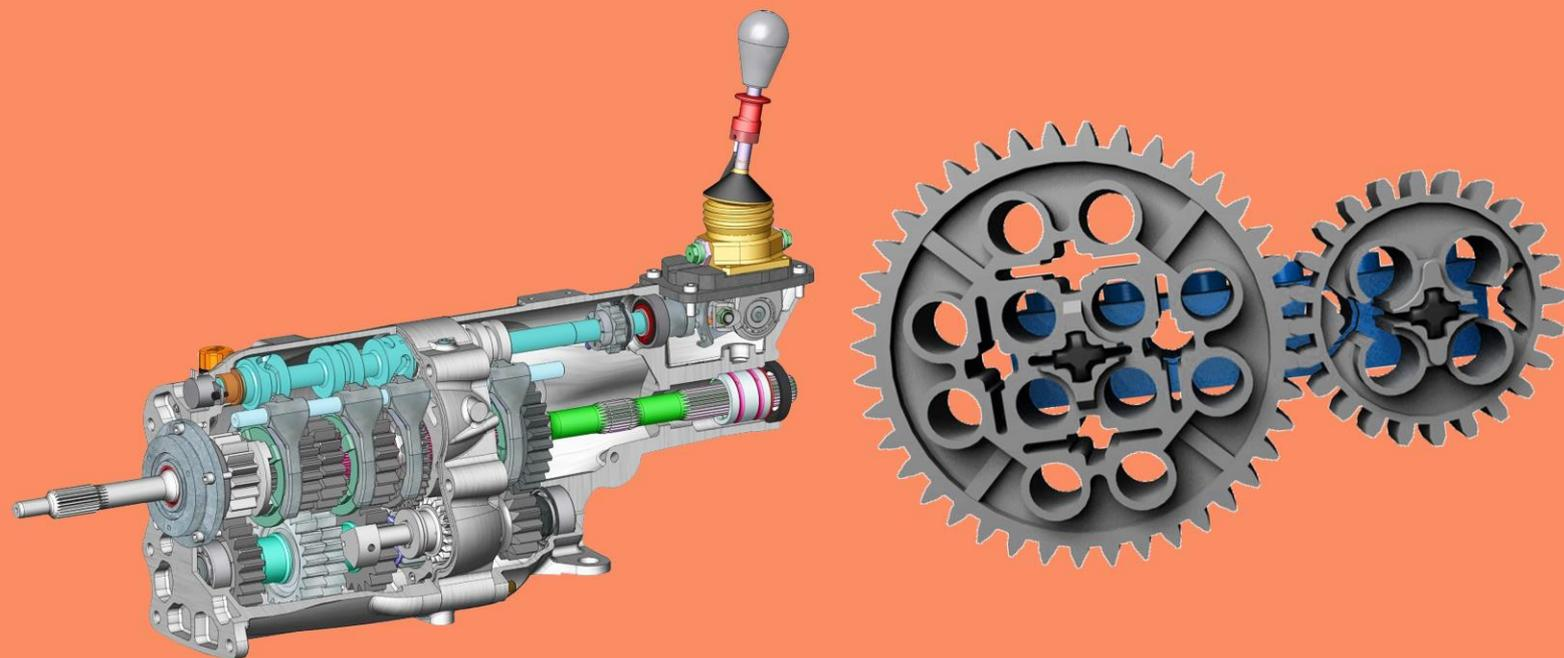
**Зубчатая передача** - передает и преобразует вращение с помощью зубчатых колес.
