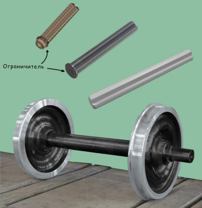
**Ось** — стержень (несущая деталь), который поддерживает вращение деталей (колёс машины или зубчатых колёс механизма) относительно всей конструкции.
